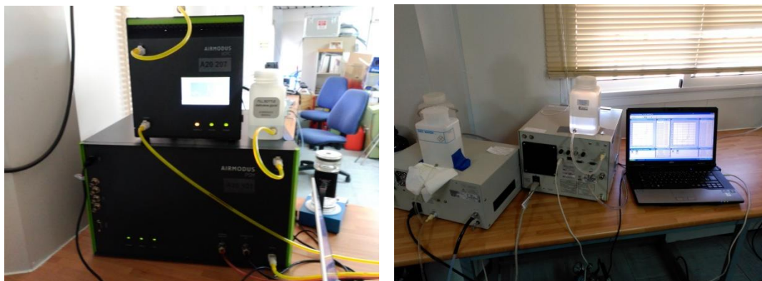
Figura 3.12. Equipos para la medida de la distribución granulométrica de las UFP desde 1nm a 800 nm. Arriba PSM Airmodus, cedido por la empresa Airmodus, representada en España por SOL-MA). Abajo equipos CPC (TSI 3783 y TSI 3776 del CSIC).
