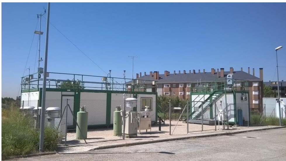
Figura 3.10. Cabinas y captadores de alto y bajo volumen ubicados en la estación del ISCIII en Majadahonda.
