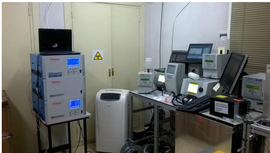
Figura 3.8. Analizadores de NO x /NH 3 y O 3 del CSIC y equipos para la medida de la distribución granulométrica de las UFP desde 1nm a 800 nm suministrados por TSI-Álava Ingenieros, instalados en la estación del CIEMAT.
