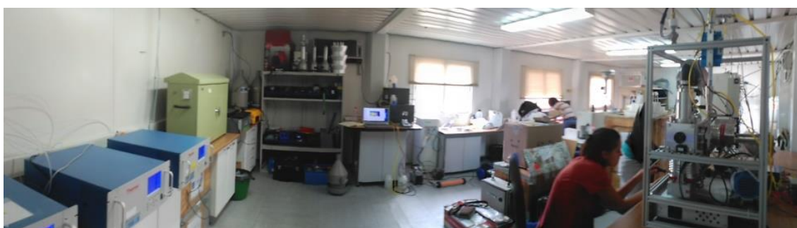
Figura 3.13. Detalle del Aerosol Chemical Speciation Monitor" (ACSM) del CSIC, instalado en la cabina del ISCIII que permite la determinación en tiempo real de sulfatos, nitratos, amonio y orgánicos.
