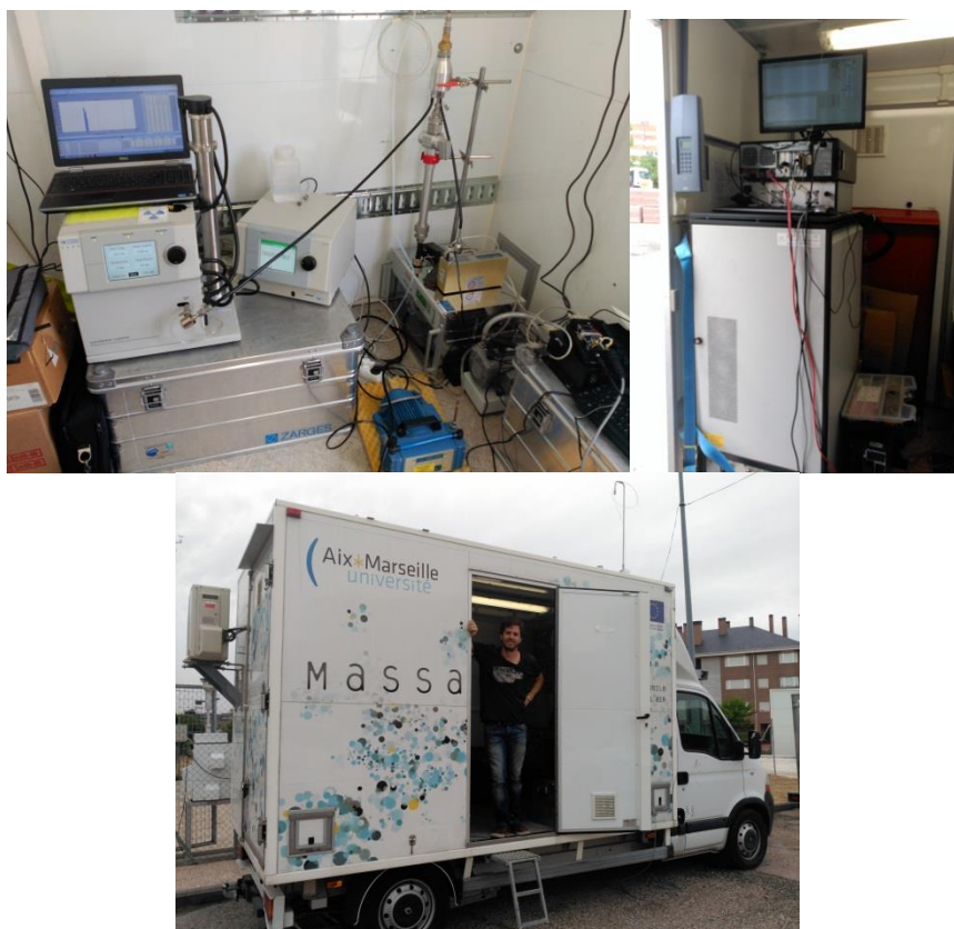
Figura 3.11. Cabina y equipos de medida (SMPS, MAAP, HR-ToF-PTRMS, GRIMM) de la unidad móvil de la Universidad de Marsella en la estación del ISCIII en Majadahonda.
