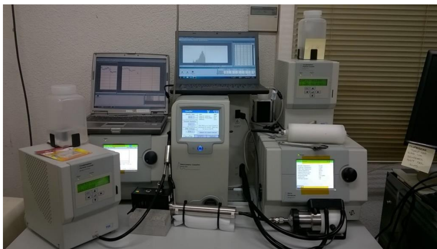
Figura 3.9. Equipos para la medida de la distribución granulométrica de las UFP desde 1nm a 800 nm (Nano Enhancer TSI 3777; SMPS TSI 3082 y CPC TSI 3772 CEN, suministrados por TSI-Álava Ingenieros, instalados en la estación del CIEMAT).
